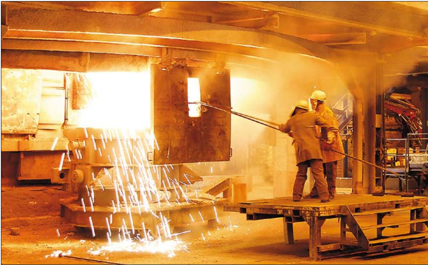
TAPPING: Nær fem tonn ferrosilicium blir tappa frå omn fire hos Elkem Bremanger. Smelteverksarbeidarane i Svelgen kan det å koke metall, ein kompetanse som er gull verdt i Elkem si satsing på solceller. (Foto: Sigbjørn Høidalen)
